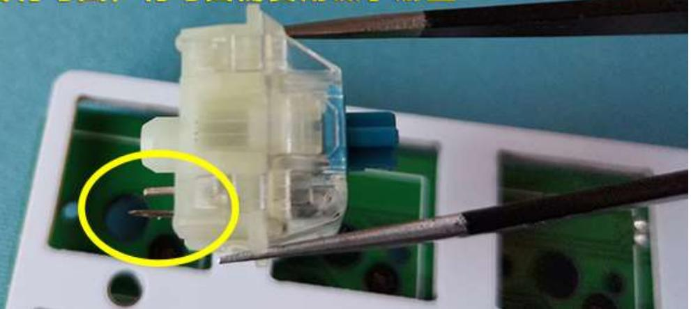
将轴脚对正PCB上的热拔插孔
