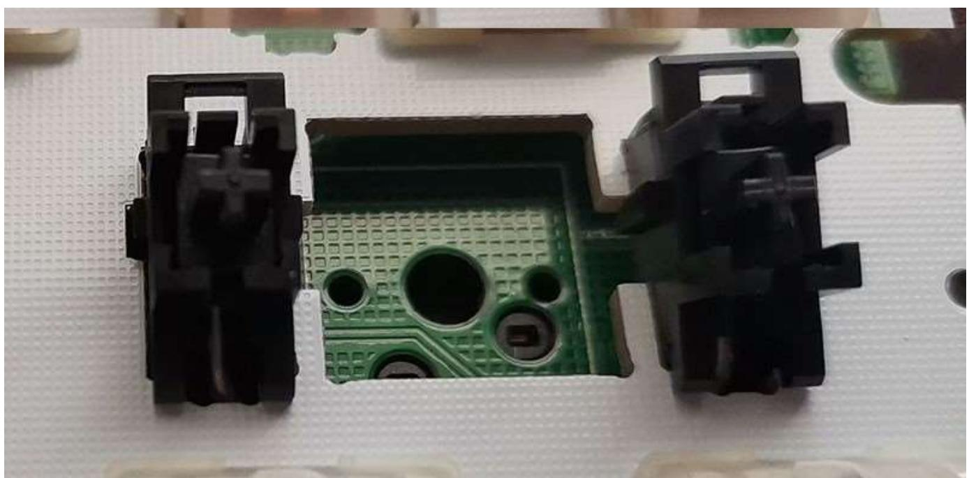
第四步：有钢丝一面B完全卡入后，将卫星轴另外一面A下压，直到另外一面卡扣卡入定位板
