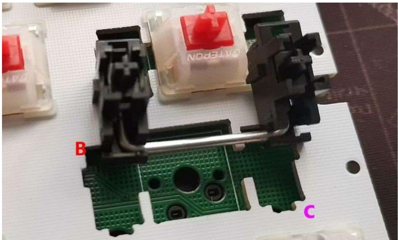
第二步：将卫星轴斜着插入卫星轴孔，钢丝要如下图通过中间缺口放到定位板下面
