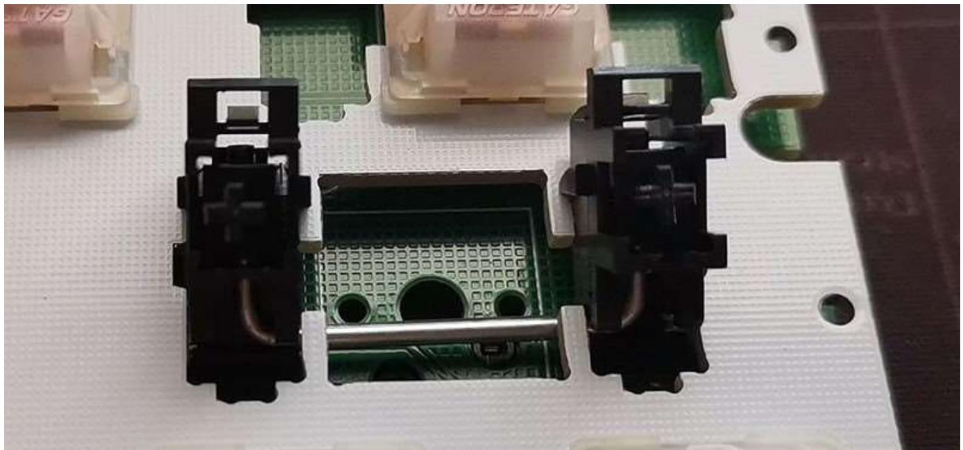
第三步：如下图，继续斜着将卫星轴卡入卫星轴孔
